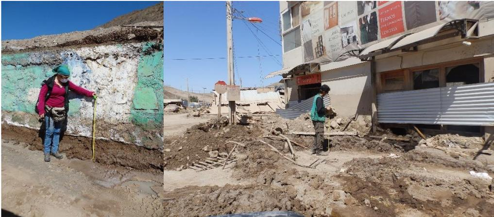
**Figura 2.** Mediciones en terreno. Izq.: Medición de altura de inundación en área urbana Chañaral. Der.: Medición altura depósito e inundación sector urbano Diego de Almagro.
