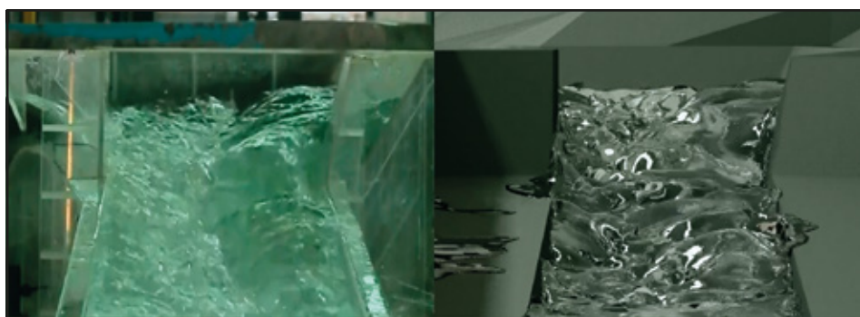
Comparación entre modelación física (izq.) y modelación numérica (der.) del evacuador del embalse Ancoa.
