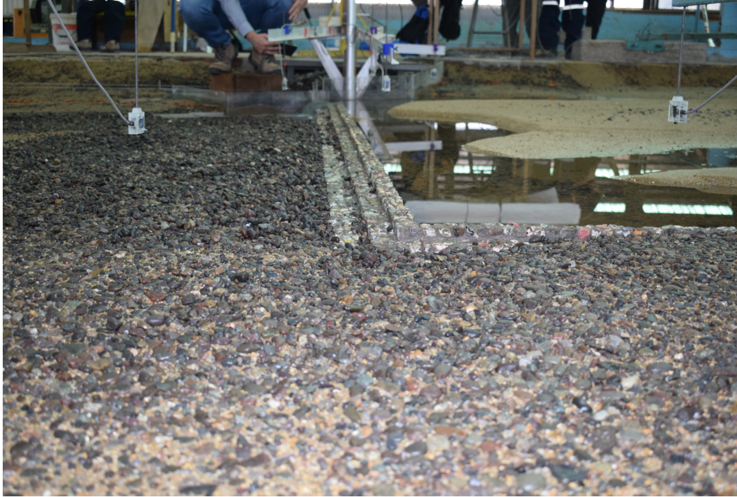
Vista del modelo físico de la barrera vertedora correspondiente a la bocatoma del Embalse Las Palmas.
