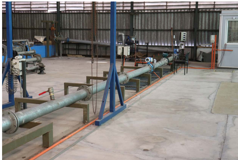
Banco de calibración de ducto cerrado.
