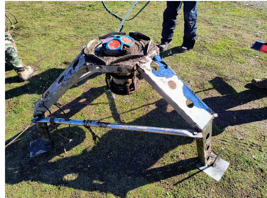
ADCP recuperado luego de medición de 1 mes en lecho fluvial.
