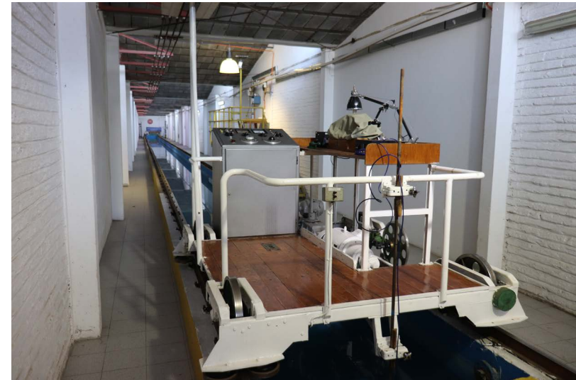
Banco de calibración canal abierto.
