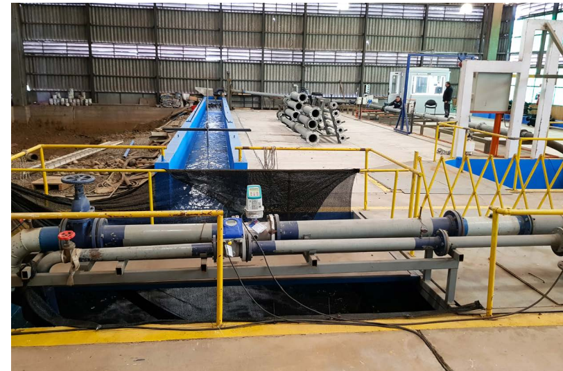
Banco de ensayo de bombas verticales y sumergibles.
