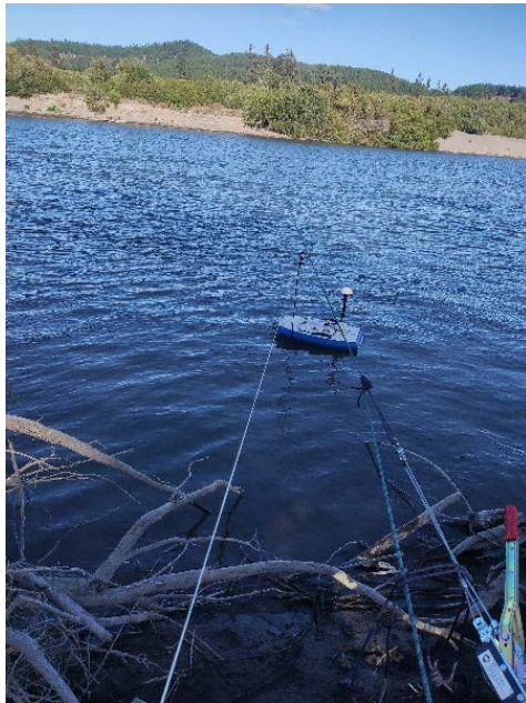
Aforo de caudal mediante equipo ADP River Surveyor.
