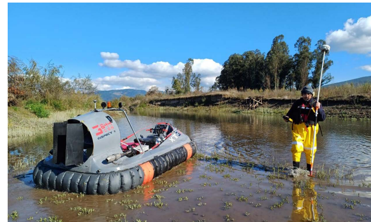
Levantamiento Topobatómico realizado con GNSS apoyado de aerodeslizador.
