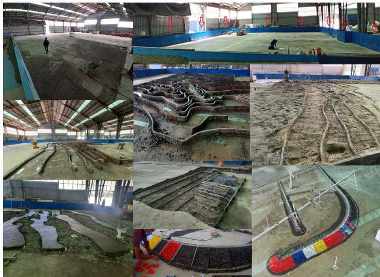
Proceso de construcción del modelo físico.
