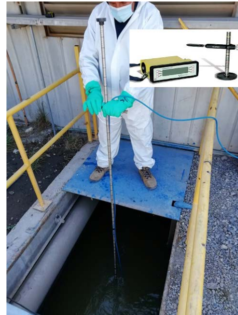
Aforo de caudal mediante flujómetro inductivo.
