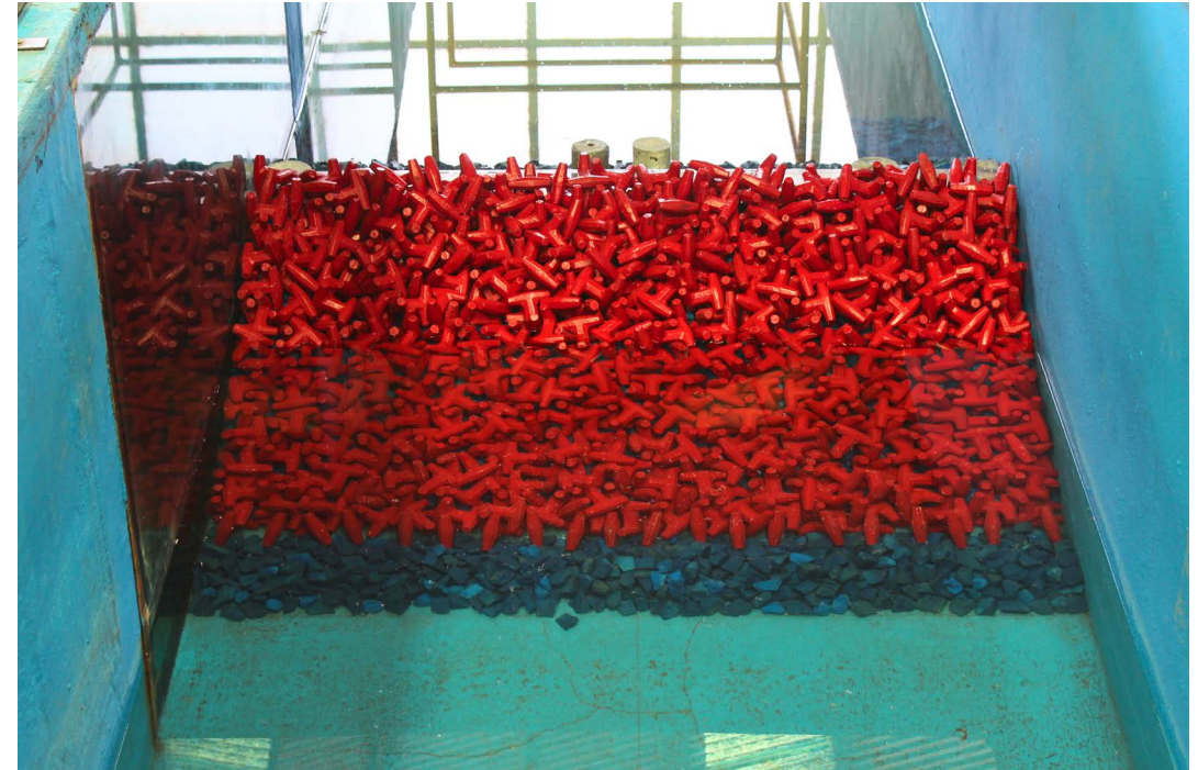
Ensayos en canal bidimensional de olas.
