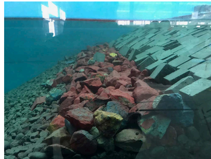
Ensayos de estabilidad y sobrepaso para una sección del rompeolas a escala reducida del Puerto de Gran Escala de San Antonio.
