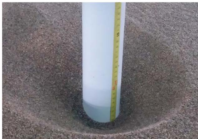
Fosa de socavación experimental con lecho de granulometría uniforme.
