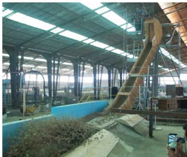
Ensayo de pulso aluvional sobre alternativa N°1, en el segundo modelo físico de la Quebrada de Macul.
