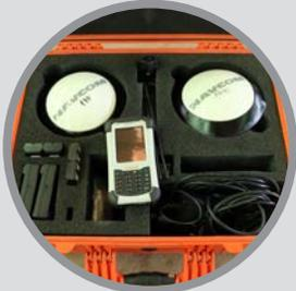
**GNSS doble frecuencia (sistema global de navegación por satélite)**
