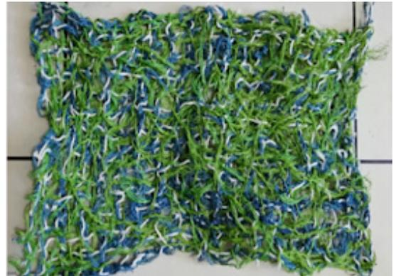
Red pecera elaborada con elementos sintéticos, utilizada para la estimación experimental del coeficiente de arrastre.
