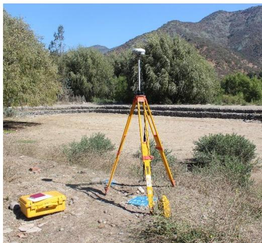
**Figura 5-46: Equipo GPS Trimble.**
